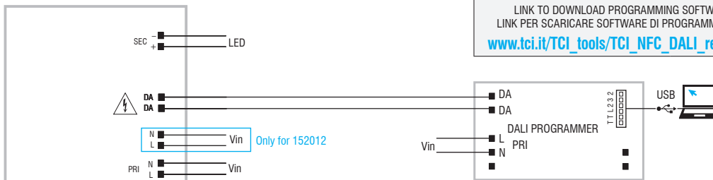
Programming via DALI - Programmazione tramite DALI
