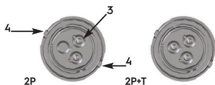
3702/V...: Anschlußbuchse (3) mit Anschlusslöchern (4) und Leitungsverschraubung
