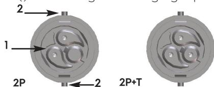
3701/V...: Steckergehäuse (1) + Abdeckung mit Befestigungszapfen (2) und Leitungsverschraubung
