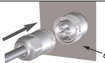
Drehen Sie die Schutzhülse "7" auf das Gehäuse der Verbindungsbuchse bis diese vollständig eingerastet ist "8".
