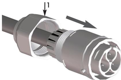
Schrauben Sie die Mutter (1) fest auf das Gehäuse (3), um die Leitungen zu fixieren und die Dichtung zusammenzudrücken. Die Mutter (1) ist mit einem Schraubenschlüssel mit einem Drehmoment von 2,5Nm anzuziehen (3).
