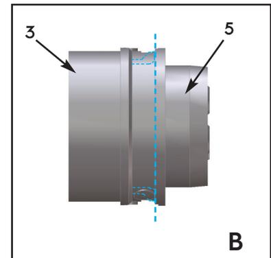
**HINWEIS** Die Verbindung (Kupplung) der beiden Teile (3, 5) ist nur einer bestimmten Position möglich. Drehen Sie die beiden Komponenten bis die Kupplung hergestellt ist (Rasthaken müssen zur Befestigung mit den Öffnungen übereinstimmen).
