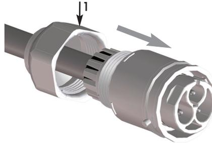
Schrauben Sie die Mutter (1) fest auf das Gehäuse (3), um die Leitungen zu fixieren und die Dichtung zusammenzudrücken. Die Mutter (1) ist mit einem Schraubenschlüssel mit einem Drehmoment von 2,5Nm anzuziehen.
