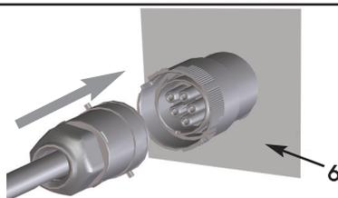
Drehen Sie die Schutzhülse "7" auf das Gehäuse der Verbindungsbuchse bis diese vollständig eingerastet ist "8".
