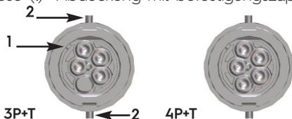
3701/M...: Steckergehäuse (1) + Abdeckung mit Befestigungszapfen (2) und Leitungsverschraubung
