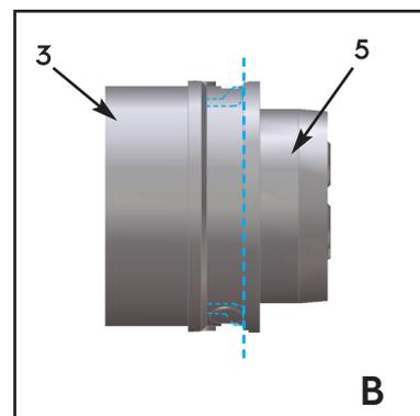
**Hinweis:** Die Verbindung (Kupplung) der beiden Teile (3, 5) ist nur einer bestimmten Position möglich. Drehen Sie die beiden Komponenten bis die Kupplung hergestellt ist (Rasthaken müssen zur Befestigung mit den Öffnungen übereinstimmen).
