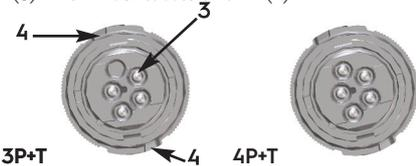
3702/M...: Anschlußbuchse (3) mit Anschlusslöchern (4) und Leitungsverschraubung
