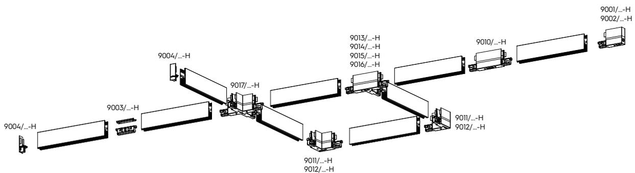
Ebenso haben Endverbinder und Stromverbinder einen meachnischen Schlüssel (wie im Bild dargestellt), der bei der auswahl der richtigen Komponente in Betracht gezogen werden muss. Im Katalog ist die Position des Schlüssel bei den entsprechenden Arikeln rot-gekennzeichnet.
