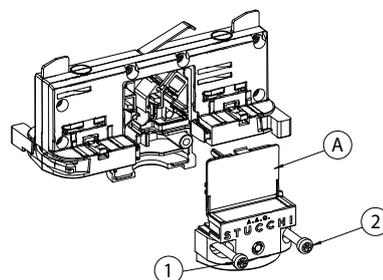
Abb. 2 Verschließen vom Adapter
