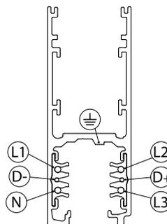
Das A.A.G. Stucchi OneTrack® System ist ein gemischtes Dreiphasensystem mit zwei zusätzlichen Leitern für die Steuerung eines allgemeinen Datensignals (z.B. DALI, DMX, ION, EIB usw.). Das System ist zertifiziert nach DIN EN 60570 und darf nur von qualifiziertem Fachpersonal installiert werden, ohne die maximale Tragfähigkeit zu übersteigen (Abb. 1). Bei der Verkabelung muss der Schaltplan (Abb. 2) beachtet werden.
