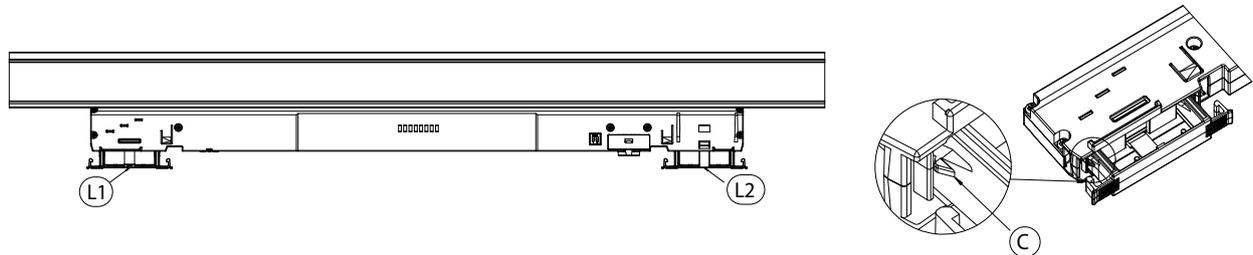
Drücken Sie den Adapter in die Stromschiene, wie in der Skizze abgebildet
