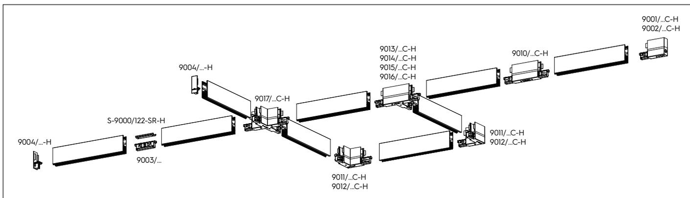
Ein mechanischer Schlüssel im Profil der Schiene gewährleistet den richtigen Anschluß der jeweiligen Verbinder. Ebenso haben Endverbinder und Stromverbinder einen mechnischen Schlüssel (wie im Bild dargestellt), der bei der Auswahl der richtigen Komponente in Betracht gezogen werden muss. Im Katalog ist die Position des Schlüssel bei den entsprechenden Arikeln rot-gekennzeichnet.
