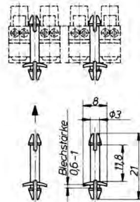
**Klemme mit schraublosen Klemmstellen und Lösemöglichkeit, 0,5-1 mm<sup>2</sup>, durchgehender Befestigungssteg.**
