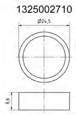
**Kunststoff-Einbaufassung E 14, einteilig mit schraubenlosen Klemmenanschluss und für werkzeuglose Steckbefestigung**
