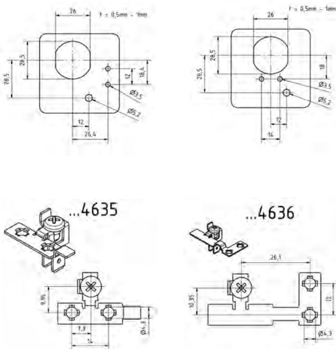
**Netzanschlusskasten 3 x 0,75 mm<sup>2</sup> bis 3 x 1,5 mm<sup>2</sup> (max. 17,5A) oder 3 x 2,5 mm<sup>2</sup> bis 3 x 4 mm<sup>2</sup> (max. 32A), 3-polig Rastbefestigung, zusätzlicher Trennsteg.**
