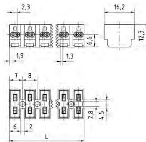
**Klemme mit schraublosen Klemmstellen, 1 mm<sup>2</sup>, teilbar, 1-12-polig, durchgehender Befestigungssteg.**
