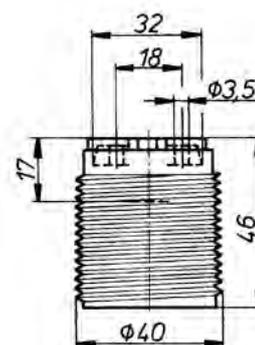
**Kunststoff-Einbaufassung E 26, einteilig mit Rastbefestigung, glattem Mantel und schraubenlosem Klemmenanschluss**
