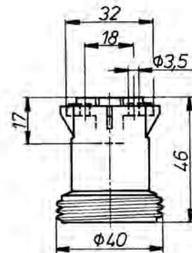
**Kunststoff-Einbaufassung E 26, einteilig mit Rastbefestigung und schraubenlosem Klemmenanschluss**
