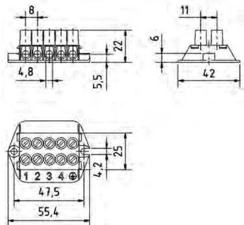
**Netzanschlusskasten 3 x 0,75 mm<sup>2</sup> bis 3 x 1,5 mm<sup>2</sup> (max. 17,5A) oder 3 x 2,5 mm<sup>2</sup> bis 3 x 4 mm<sup>2</sup> (max. 32A), 3-polig Rastbefestigung.**
