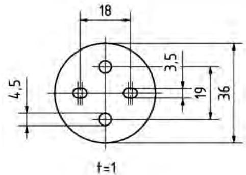
**Porzellan-Einbaufassung E 27, einteilig mit Buchsenklemmenanschluss außen, Neigungswinkel 7 °**
