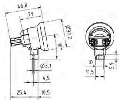
**Kunststoff-Einbaufassung E 27, einteilig mit 10x20 Rastfuß und schraubenlosem Klemmenanschluss**
