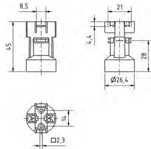
**Kunststoff-Einbaufassung E 14, einteilig mit Steck- und Rastbefestigung, kurzem Außengewinde und schraubenlosen Klemmenanschluss**
