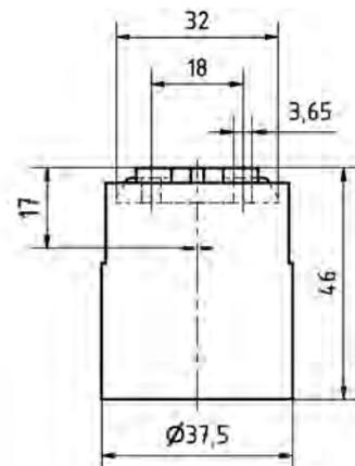
**Kunststoff-Einbaufassung E 26, einteilig mit Rastbefestigung, kurzem Außengewinde und schraubenlosem Klemmenanschluss**
