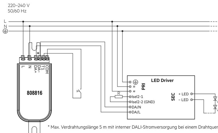
\* Max. Verdrahtungslänge 5 m mit interner DALI-Stromversorgung bei einem Drahtquerschnitt von 1 mm<sup>2</sup>.
