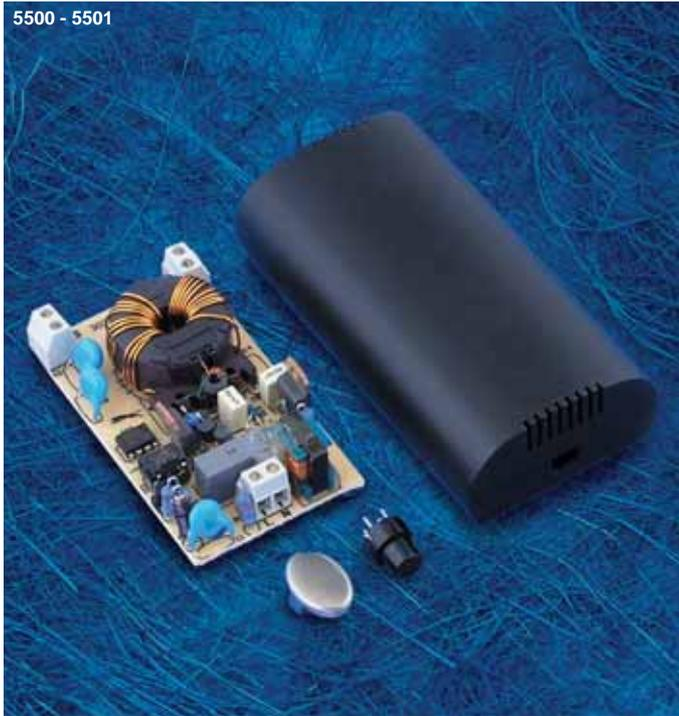
Transformateurs électroniques avec réglage incorporé et commande externe. Régulation sensorielle (S) ou avec bouton (P).
