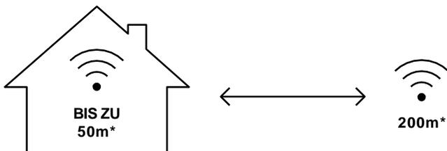
\*Die Funkreichweite eines Casambi-Geräts hängt von mehreren Faktoren ab: wie es in eine Leuchte integriert wurde, wo es installiert wurde und unter Berücksichtigung von Hindernissen in der Umgebung, wie z. B. Wänden und anderen Baumaterialien, die Signale blockieren können.
