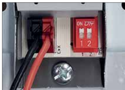
Dip switch per la selezione della corrente in uscita Equipped with dip switch for selection the output current
