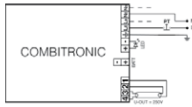
SCHEMA DI COLLEGAMENTO - CIRCUITO DI TEST - STANDARD WIRING DIAGRAM TEST CIRCUIT SCHALTBILDER FÜR ABSCHALTSYSTEME - TESTKREIS SCHEMAS DE BRANCHEMENT STANDARD - CIRCUIT DE CONTROLE
