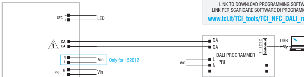
Programming via DALI - Programmazione tramite DALI
